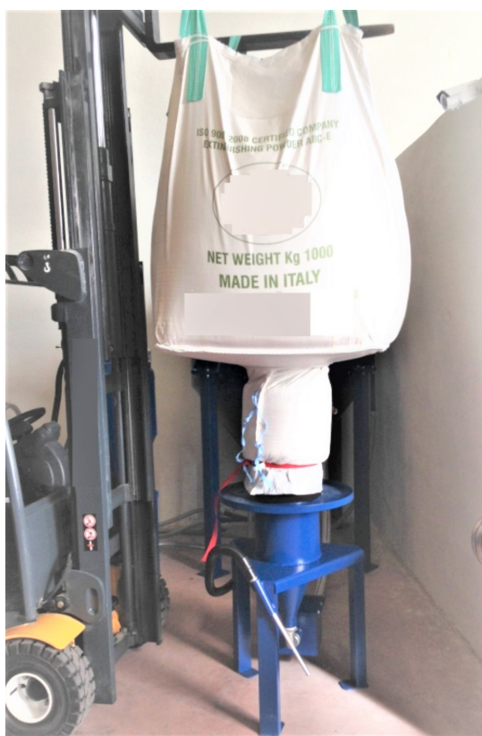
Svuotamento del big bag nel serbatoio tramite la tramoggia
